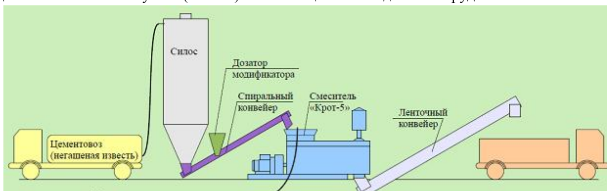
Рисунок 3. Принципиальная технологическая схема
